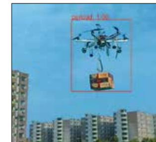
Abb. 5: Die Erkennung von Nutzlasten ermöglicht die Einschätzung der Gefährlichkeit und damit auch eine Priorisierung der Bekämpfung bei der Detektion eines Drohnenschwarms
