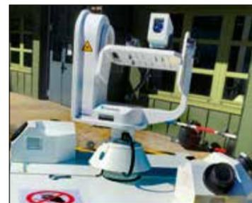
Abb. 3: IOSB-Experimentalsystem MODEAS zur optischen Detektion, Tracking und Analyse von anfliegenden Drohnen
