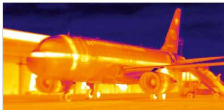
Abb. 1: Airbus A319 OH im Wärmebild (Thermales Infrarot) während einer Kampagne zur Gewinnung von Testdaten (Quelle: Bundeswehr / Michael Donaubaue)
