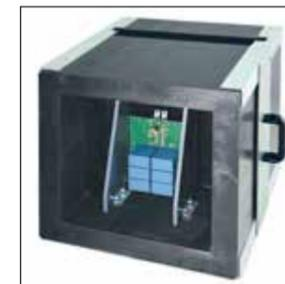
Abb. 4: Abschirmbox für selektive Neutronenbestrahlung
