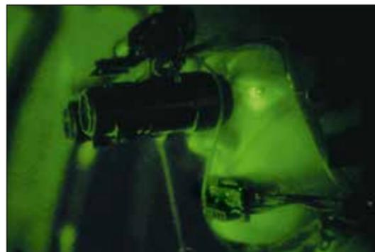
Abb. 1: BiV-Brillen werden durch Fahrzeugführende üblicherweise auf einen Helm geclipst. Der Sichtbereich der BiV-Brille ist deutlich begrenzt (Quelle: Wikimedia Commons)
