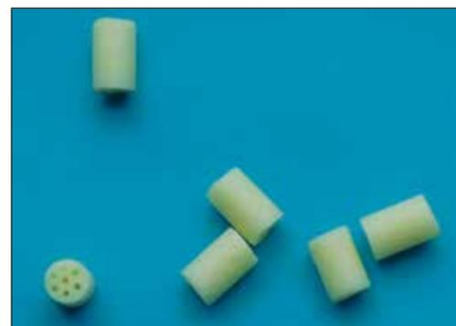
Abb. 1: Kunststoffgebundenes Treibladungspulver in zylindrischer 7-Loch-Geometrie zur Evaluierung neuer Materialien und Formulierungszusammensetzungen, wie zum Beispiel neuer und moderner Nitrat-basierter und Azido-Weichmacher
