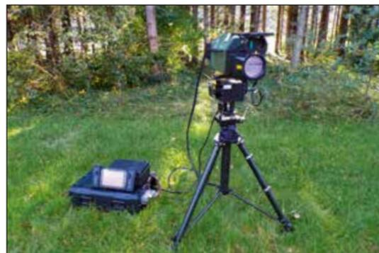
Abb. 1: Erprobungsmuster MILOS-D bestehend aus Lasereffektor, Richteinheit, Dreibeinstativ, Laserquelle, Batterie und Tablet
