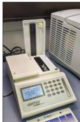
Abb. 1: Das Alethia Malaria LAMP System erfüllt alle Anforderungen eines Point-of-Care-Diagnostiksystems
