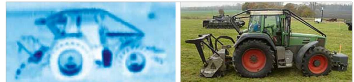
Abb. 3: Beispiel einer radiometrischen Abbildung im Frequenzbereich 80 – 100 GHz mittels klassischer Scanner- und Empfängertechnologie (links). Rydberg-Sensoren könnten hierfür zur deutlichen Performanzsteigerung Verwendung finden. Radiometrische Aufnahmen ähneln in der Interpretierbarkeit optischen Bildern (rechts) und sind auch bei widrigen Sichtverhältnissen möglich
