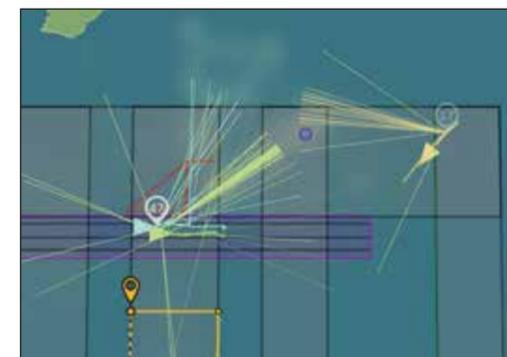
Abb. 3: Nahezu-Echtzeit-Lagebildkarte in SeaSuite vom 18. Sept. 2024 mit Positionen und Tracks der drei Glider, sowie mit Richtungsanzeigen der akustischen Detektion des laufenden Tages. Alle drei Glider scheinen ein akustisches Ziel in demselben Gebiet detektiert zu haben
