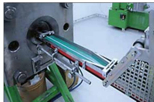
Abb. 2: Strangpresseextrusion im Technikumsmaßstab am Fraunhofer ICT ermöglicht die Herstellung von Kleinchargen für die TLP-Entwicklung und -Charakterisierung sowie die Bemusterung umfangreicher Beschusskampagnen
