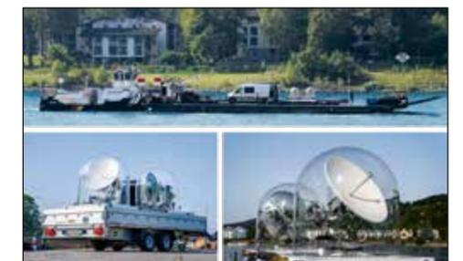
Abb. 4: SABBIA®-System montiert auf einem beweglichen Schiff
