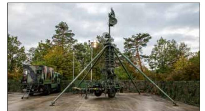
Abb. 4: Terrestrisches Übertragungssystem (TÜtrSys) für große Reichweiten (Quelle: Bundeswehr / Martina Pump)
