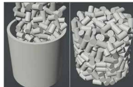
Abb. 2: Befüllungsprozess eines generischen Ladungsraums (links) und resultierendes Pulverbett (rechts)
