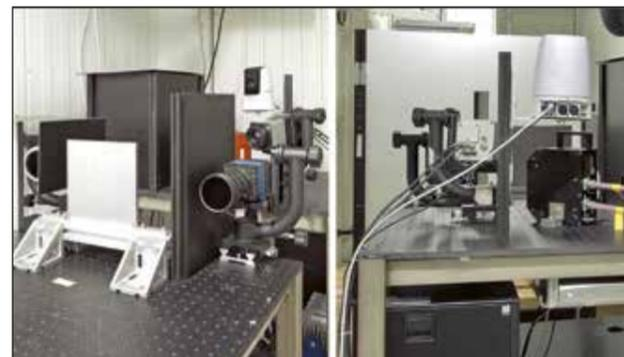
Abb. 1: HEL Wechselwirkungslabor, links: Targetbereich mit Sensoren und Kameras; rechts: Ansicht von der Rückseite, Streuschirm im Hintergrund (Distanz zwischen Schirm und Target 1 m)
