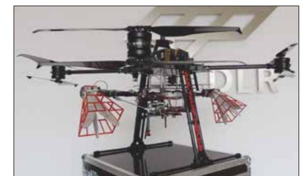
Abb. 4: F&T-Demonstrator eines UAV-getragenen Bodensensordaten (GPR) Systems zur Kampfmitteldetektion
