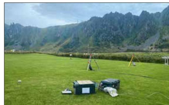
Abb. 1: Die beiden ISL GNSS-Systeme auf dem Versuchsgelände. Die high-power Jammer befinden sich auf der Bergkette in 1,5 km Entfernung
