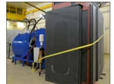
Abb. 6: Neutronenstrahlen-Testkammer am WIS mit Abschirmung
