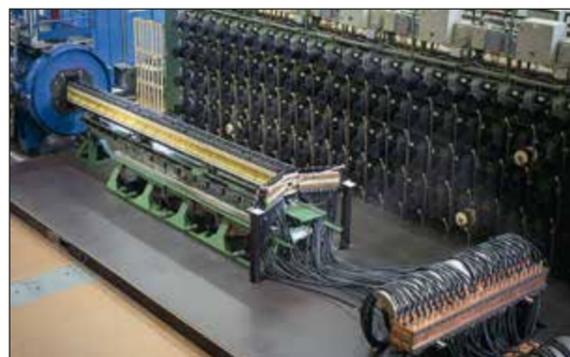
Abb. 1: Schienenkanone NGL 60 „PEGASUS“ und kondensatorbasierte Versorgungsanlage
