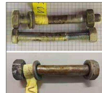
Abb. 3: Aus dem Teststand herausgezogene Schrauben nach Explosion M12 (oben) und M16 (unten)
