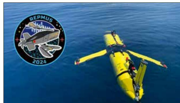
Abb. 1: Der Slocum Glider der WTD 71 während eines auf See durchgeführten Tauschs von Hydrofonen. Bei diesem Glider ist das akustische Aufzeichnungssystem OceanObserver in den Glider integriert. Im Bild eingebettet ist das offizielle REPMUS24-Logo
