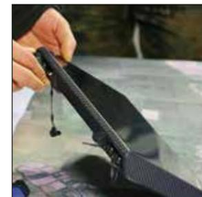
Abb. 4: Model BACKBONE® der Firma MUSE, Wechsel Sicherheitsdomäne mittels Austausch Dongel
