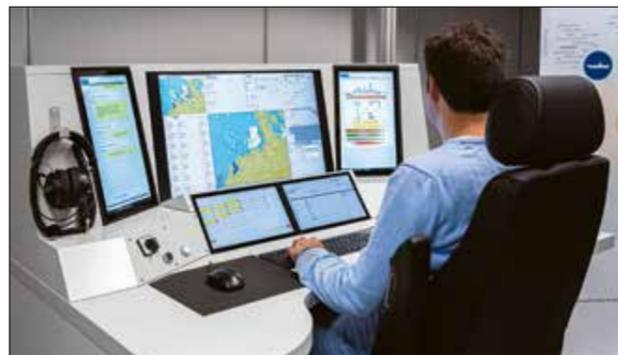
Abb. 1: Realisierung Standardkonsole mit COTS-Hardware
