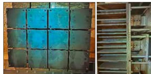
Abb. 1: Entwickelter Versuchsstand zur Prüfung von Schraubverbindungen unter Explosionslast
