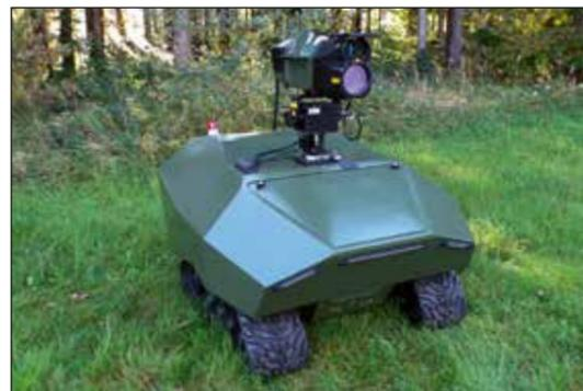
Abb. 2: Lasereffektor mit Richteinheit aufgebaut auf UGV-Selbstfahrplattform Rovo
