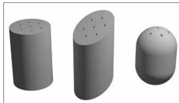
Abb. 1: CAD-Modell eines konventionell gefertigten zylindrischen Treibladungspulvers mit variierendem Schnittwinkel (links, mitte) und eines nicht konventionell herstellbaren Treibladungspulvers (rechts)
