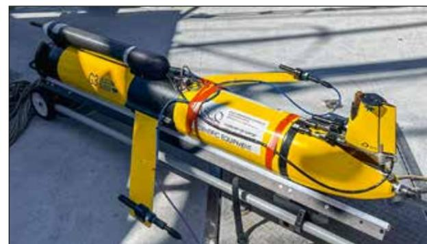
Abb. 2: Einer der beiden Glider von TWR. Bei beiden TWR-Glidern war der OceanObserver auf dem Glider montiert. Im Rahmen der Auswertung werden die Vor- und Nachteile der unterschiedlichen Konfigurationen untersucht (z. B. Strömungswiderstand, akustisches Eigengeräusch, Wartungsfreundlichkeit)
