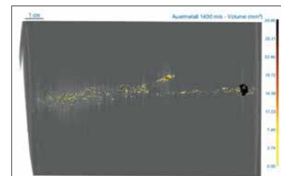
Abb. 3: Resultierende 3D-Rekonstruktion nach Messung der Fragmente in der Computertomographie-Anlage. In Grau das Soft-Catch Medium und von Gelb nach Schwarz Fragmente mit zunehmendem Volumen
