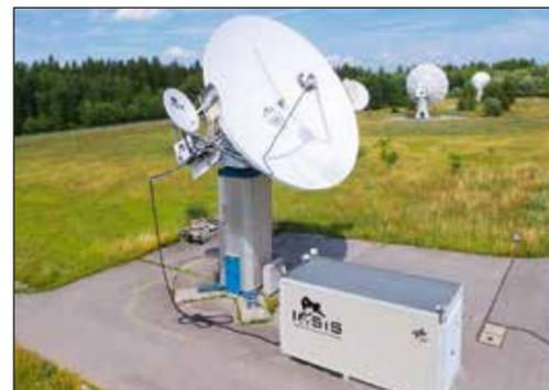
Abb. 1: IoSiS-Radaranlage am DLR-Standort Weilheim in Oberbayern. Die mittelgroße Antenne wird für das Senden, die beiden seitlich angebrachten kleinen Antennen werden für das Empfangen verwendet
